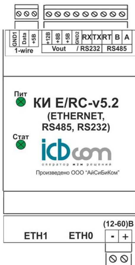
Рисунок 2 – Вид устройства с обозначением разъемов
